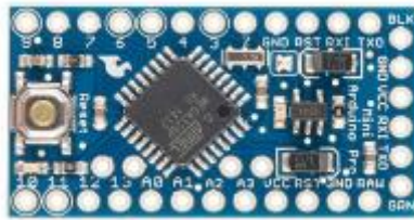
Fig. 6. Arduino Pro Mini (3.3V, 8Mhz) – Flight Computer
